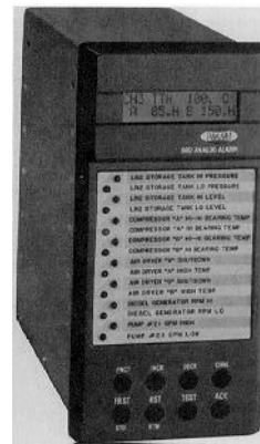
Fig. 16.28. Monitor dedicado a monitoração de compressor
